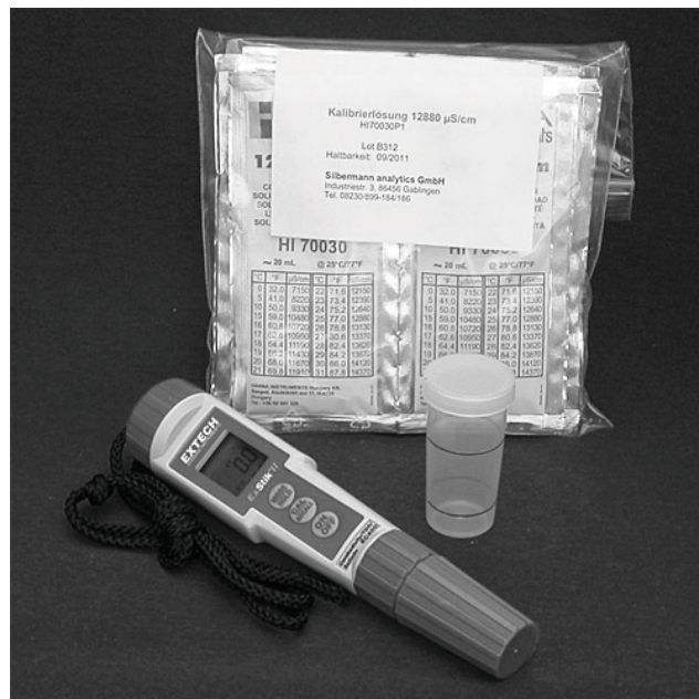
Abb. 2: Leitfähigkeitsmessung (EC) und Kalibrierlösung (Einwegtütchen)
