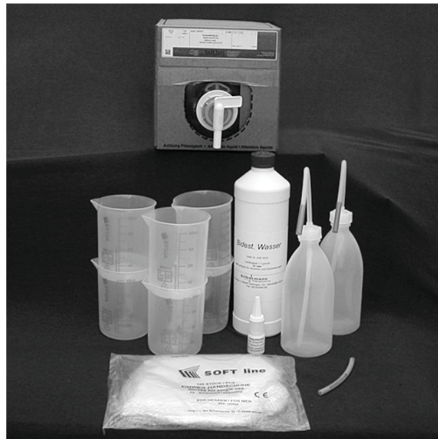
Abb. 3: Zubehör FOS/TAC-Titrierset: mit Säure, Dest. Wasser, Ersatzschlauch, Schaumstopp
